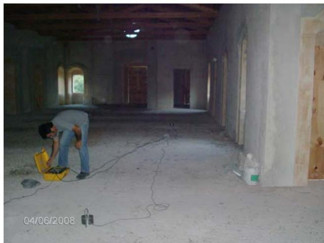
Figura 10 – Posizionamento geofoni per misure passive
